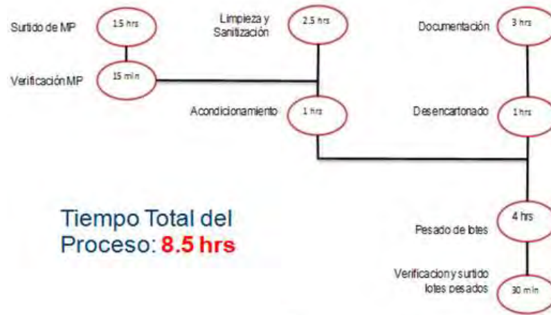
Figura 1 Diagrama de flujo del proceso de materia prima.
