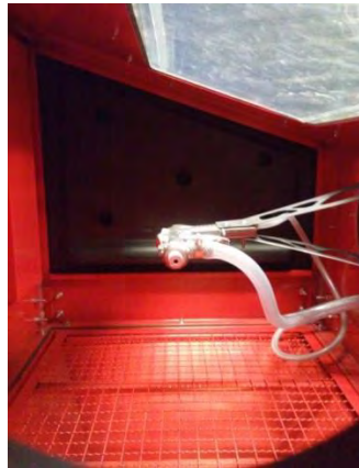
Figura 3. Pistola fija donde sale la arena a presión con dirección a las probetas.
