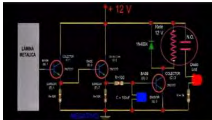
Figura 2 Circuito electrónico de sensor capacitivo
