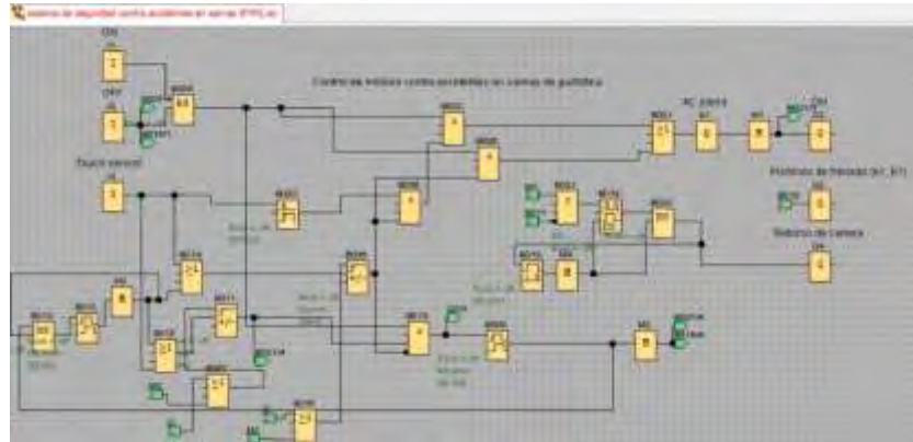
Figura 5 Programación en bloque para el PLC Siemens Logo
