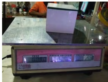
Figura 5. Cuantificación de la masa del recipiente vacío de la muestra granulométrica de PET.
