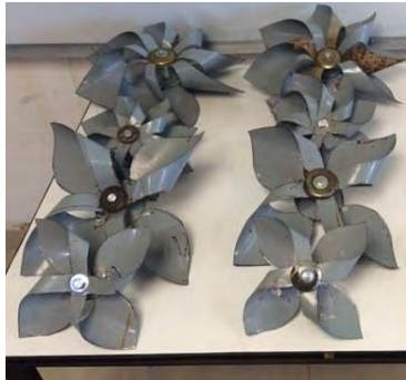
Figura 1- Prototipos de Turbinas Tipo Rehilete con 4 y 8 alabes.
