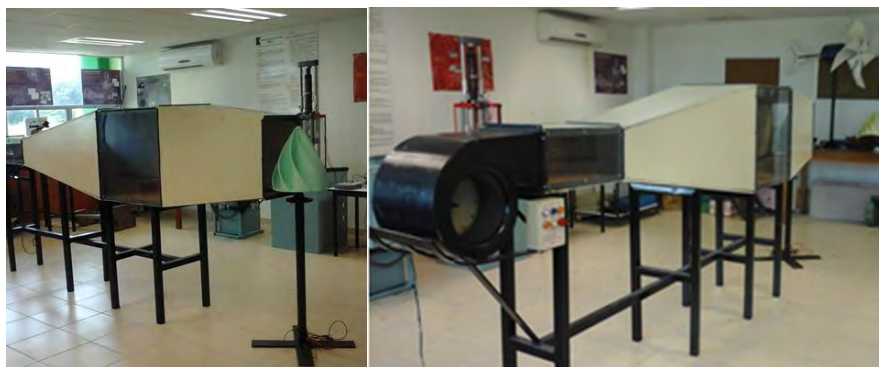
Fig.9- Túnel de viento TVE3-10 para ensayos de turbinas eólicas a nivel de laboratorio.
