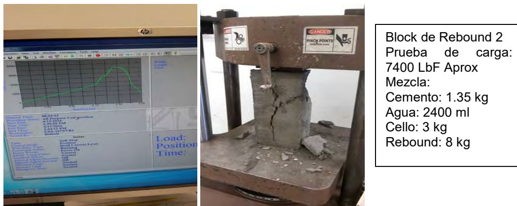
Figura 5. Prueba a Block agregando 3kg de cello y 1.35kg de cemento
