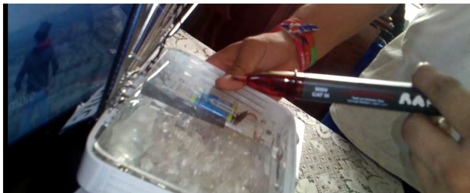
Figura 7.- Medidor sin detectar el campo electromagnético por la interferencia del dispositivo.
