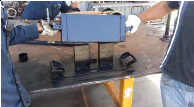
Figura 3 molde para realizar los bloques
