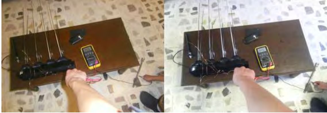
Figura 4.- Sistema de antenas para medir la energía eléctrica producida por radiación electromagnética en el ambiente.
