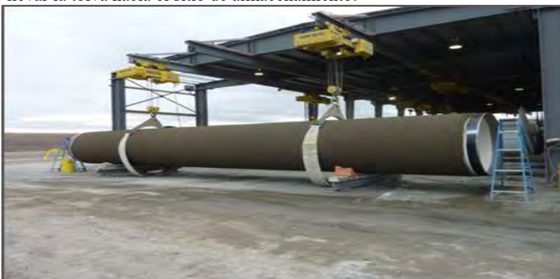
Figura 2 cemento aplicado en el proceso de Coating.
