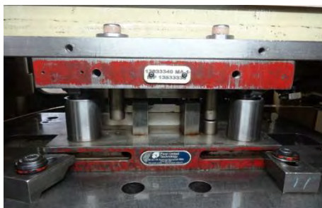
Figura 1- Troquel para fabricación de terminales
