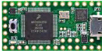
Figura 4. Microcotrolador ARM Cortex-4M de 32 bits
