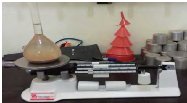
Figura 7. Prueba densidad de sólidos
