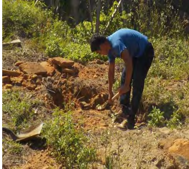
Figura 2. Toma de la muestra con Pozo a Cielo Abierto
