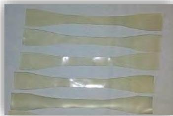
Figura 1. Probetas para prueba mecánica de tensión
