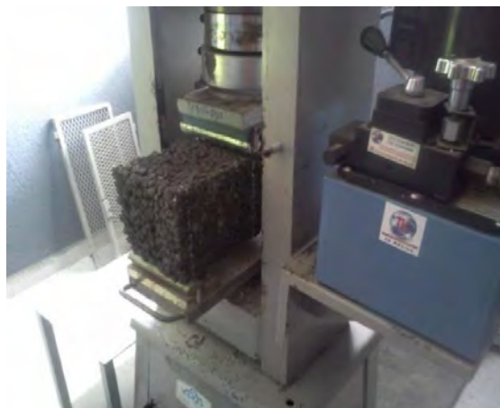
Figura 8. Ensaye a flexión con carga en los tercios. Fuente. Empresa GORSA.
