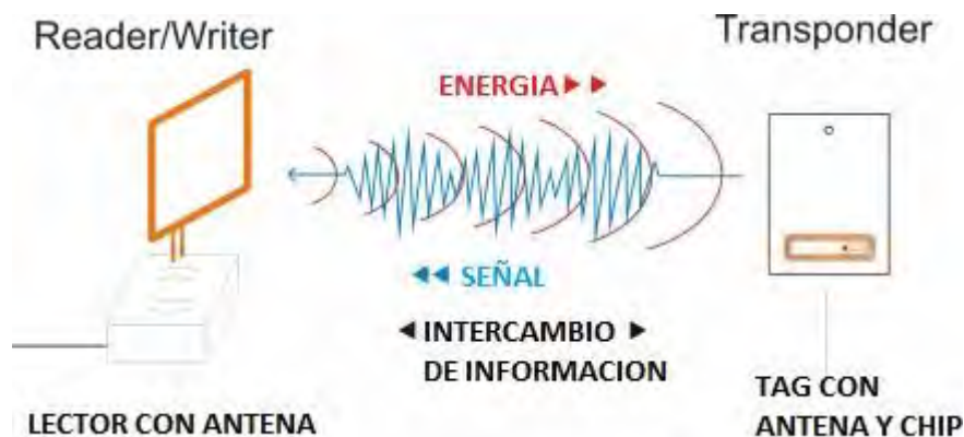
Figura 2. Diagrama de elementos básicos en la tecnología RFID.
