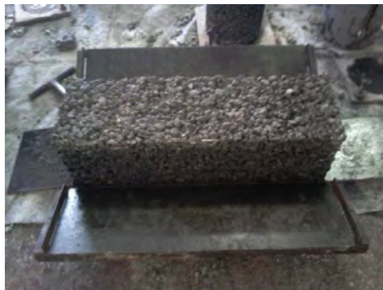
Figura 6. Viga para prueba a flexión Fuente. Empresa GORSA.
