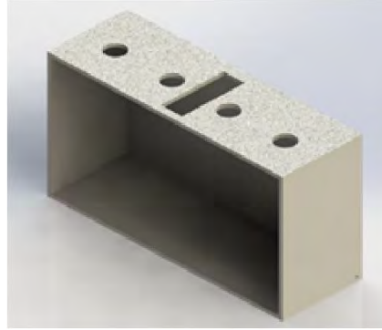
Figura 5. Aislante elegido, espuma de poliuretano.
