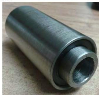
Figura 10. Buje prototipo ensamblado.
