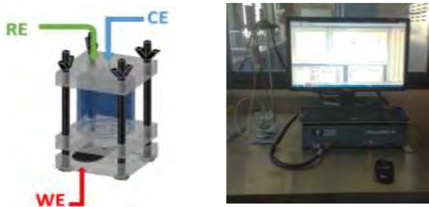
Fig. 2. Celda electroquímica de 3 electrodos; RE (referencia), CE (contra electrodo) y WE (trabajo). Celda electroquímica conectada al potenciostato & galvanostato VERSASTAT-400.
