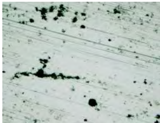
Fig. 8. Ataque sobre la muestra con inhibidor
