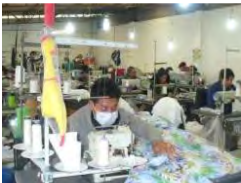
Figura 5. Operador de máquina overlock
