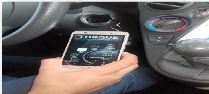
Fig. 5 Conexión vía Bluetooth con la herramienta Torque.
