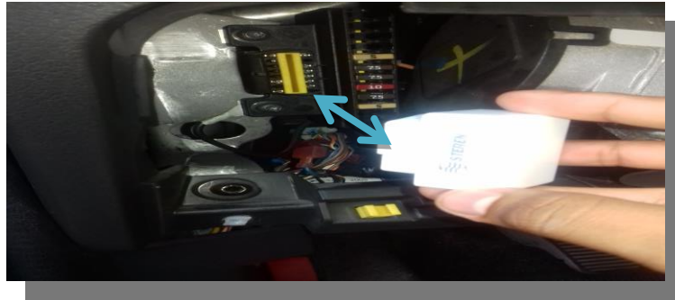
Fig. 3 Identificación de la interfaz OBD-II.
