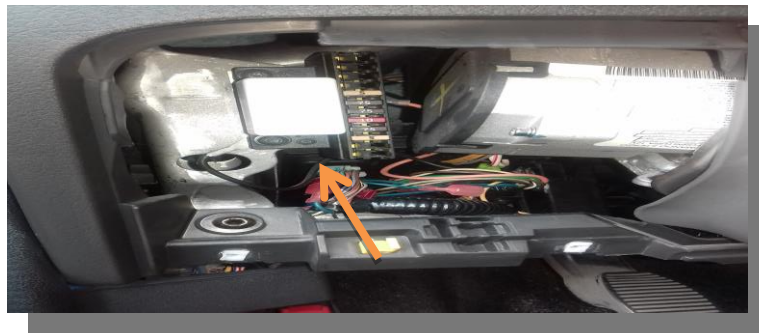
Fig. 4 Conexión del escáner ELM327 en el Automóvil.
