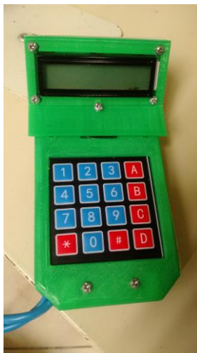
Fig. 5: Carátula impresa en 3D para el control que forma parte del sistema embebido.
