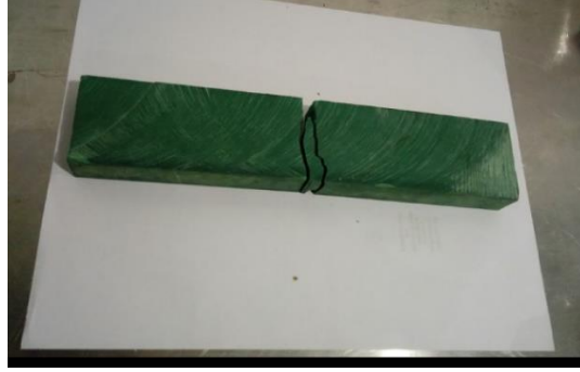
Figura 4.27 probeta de NECURON 1001 después del ensaye de flexión
