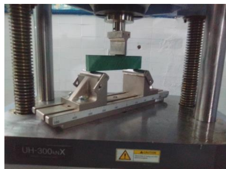
Figura 4.20 probeta instalada en la maquina Universal SHIMADZU
