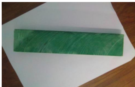
Figura 4.26 probeta de NECURON 1001 antes de la prueba de ensaye de flexión
