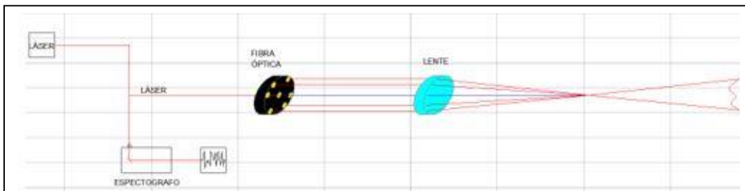
Figura 1. El sistema de recolección de datos que consiste de: Un láser, una sonda de fibra óptica bifurcada con salida de emisión láser por 6 fibras ópticas, y por retroreflexión una fibra central que colecta la información que genera el objeto móvil en la zona de interferencia, y un espectrógrafo con cámara CCD, y una PC convencional.
