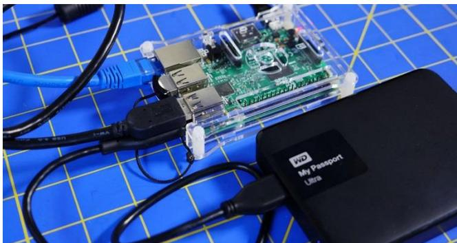
Figura 1. Disco duro conectado a puerto USB de la raspberry pi 3 Modelo B
