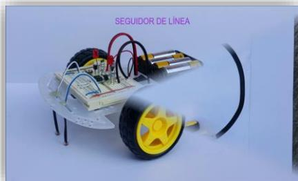
Figura 4 Robot móvil seguidor de línea.
