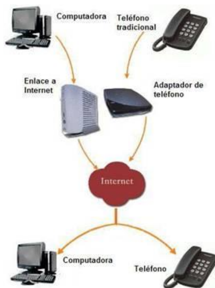
Figura1: Modelo de sistema de telefonía tradicional y voz sobre IP
