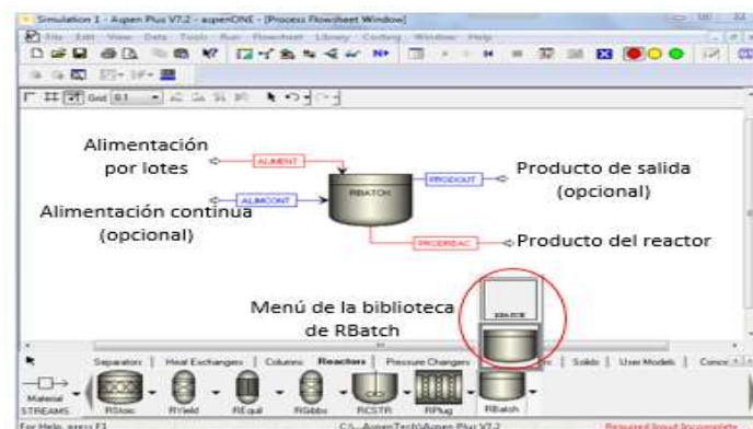
Figura 3. Modelo de reactor batch en Aspen Plus
