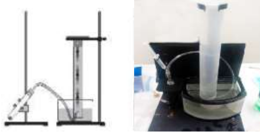
Figura 1. Montaje experimental de la producción de hidrógeno
