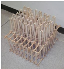
Figuras.-7 al 10: El armado de los contra vientos fue una de las conexiones claves para funcionalidad de cubierta. En este caso, cada módulo que se conectó, fue observado si se plegaba correctamente. Fuente: Fotos Experimentales. Morales, (2010).
