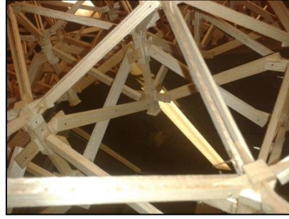
Figura.- 2, 3: El modelo escalado a 1:20 ayudó a conceptualizar la elaboración del nodo constructivo, de igual manera la utilización de un software especializado ayudó a modelar con más eficiencia las conexiones que podría tener el sistema plegable de la cubierta. Fuente: Fotos Experimentales. Morales, (2011).
