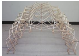
Figuras.-7 al 10: El armado de los contra vientos fue una de las conexiones claves para funcionalidad de cubierta. En este caso, cada módulo que se conectó, fue observado si se plegaba correctamente. Fuente: Fotos Experimentales. Morales, (2010).
