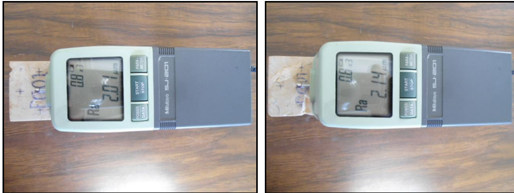
Figura 10. Fotografías de la medición de la rugosidad final de las probetas PC01 y PC07
