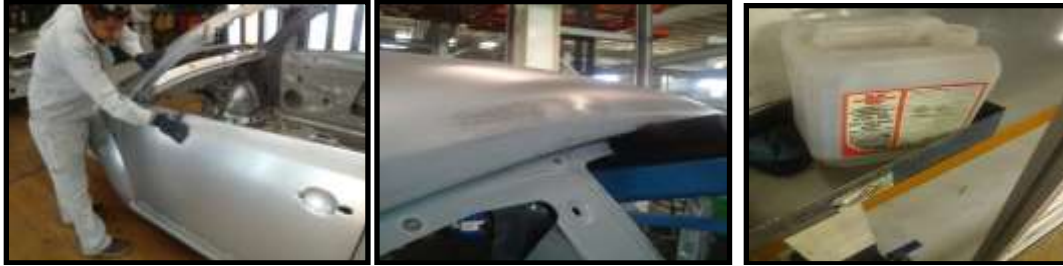
Figura 6. Técnicas para la detección de abollones: tacto, tallado y espejo.
