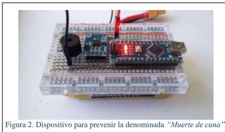
Nuestro dispositivo se programó utilizando el software IDE de Arduino. Cabe mencionar que primero se utilizó a la placa microcontroladora Arduino uno pero debido al tamaño se optó finalmente utilizar a la placa microcontroladora nanoarduino.
