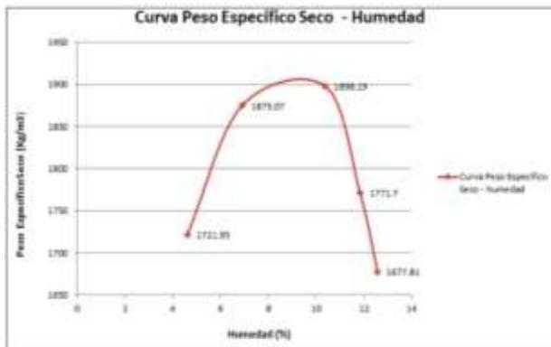
Gráfica 1. Curva Peso Especifico Seco Máximo – Humedad para el Sahcab
