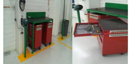
Figura 14 Se le asignó e identifico un lugar específico a cada herramienta con el fin de que solo encaje en su sitio la correcta para poder localizarle rápidamente
