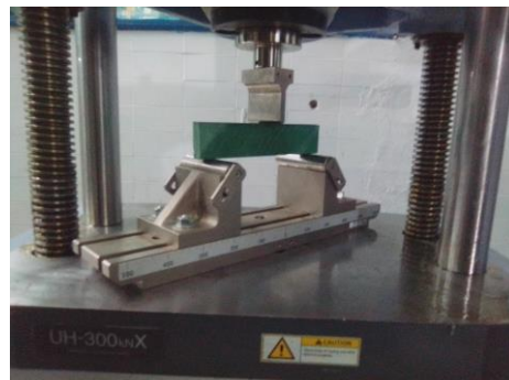
Figura 4.20 probeta instalada en la maquina Universal SHIMADZU
