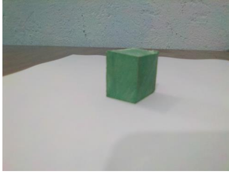
Figura 4.17 probeta del material de NECURON ensaye de compresión
