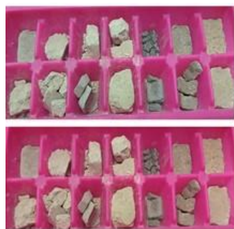
Figura 6 Muestras para definir la molaridad Idónea y escala de dureza de Mohr (Autor)
