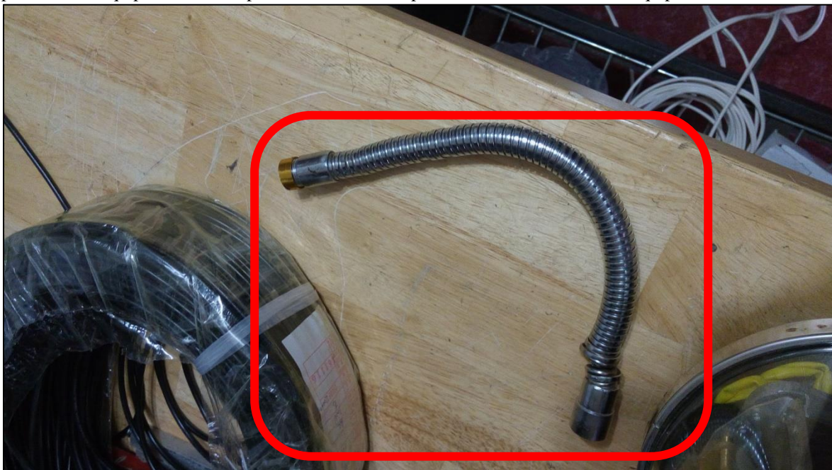
Figura 2.- Soporte utilizado para alineación del sensor dañado
