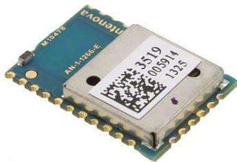
Figura 5: El módulo GPS M10478 GPS de Antenna integra el sistema de antenna.
