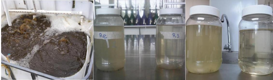
Figura 7.- Muestra del reactor SBR, operando, en la imagen central resultados con un TRH de 15 horas y a la derecha un TRH de 20 horas.
