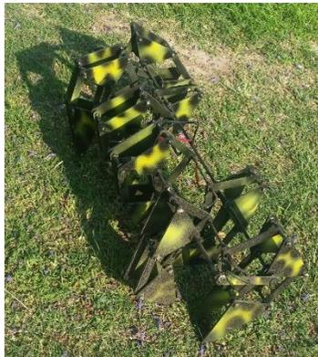
Figura 11. Segundo prototipo de mecanismo de Theo Jansen.
