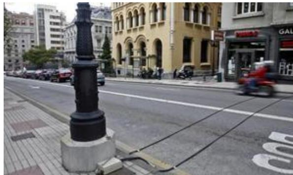
Figura 1. Aforador de tráfico
