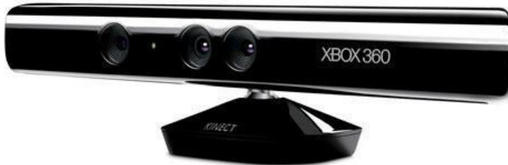
Figura3. Se presenta el Kinect utilizado para reconocer los gestos
