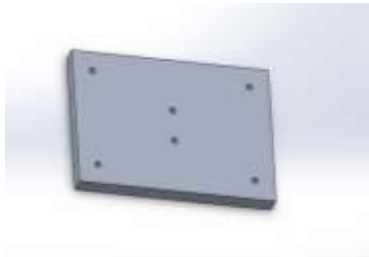
Placa 1: Esta placa está hecha de aluminio y es el soporte de todo nuestro motor.
