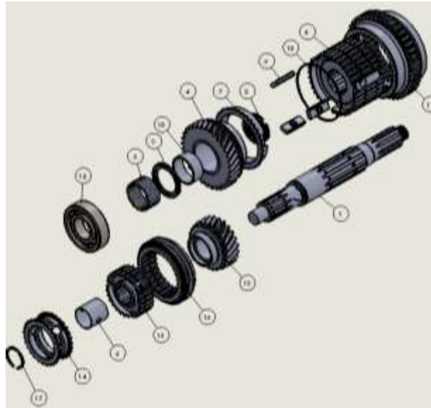
Figura 1. Ensamble explosionado de la caja de velocidades realizado con el CAD.
