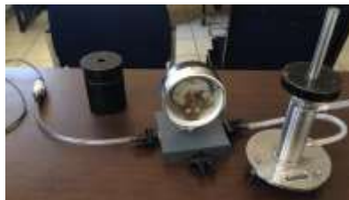
Figura 11. Medidor de peso muerto conectado al sensor de presión.
