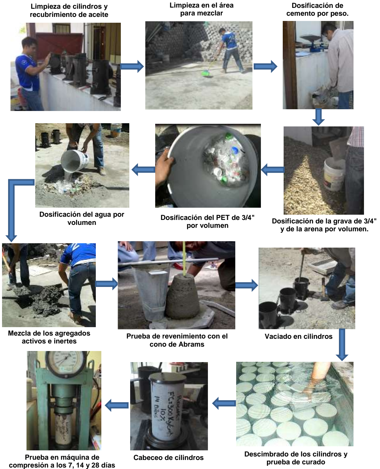
Diagrama 1. Fabricación de concreto estructural sustentable para clase I y clase II. (Elaborado por autores).
