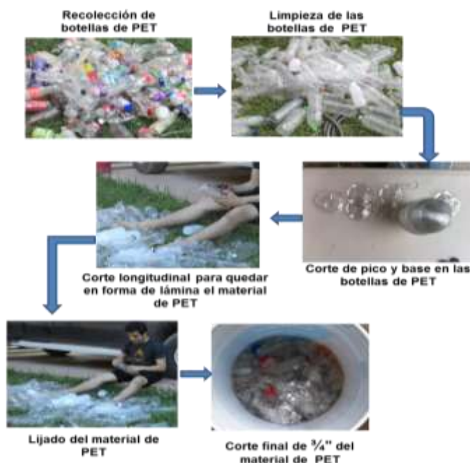
Diagrama 1. Recolección de Pet y proceso para obtener granulometría para agregado grueso del concreto sustentable ROCAPET. (Fuente: Elaborada por autores).
