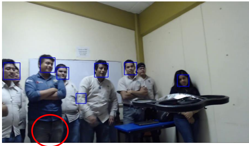
Figura 2. Identificación de múltiples rostros con un error de falso positivo seña
