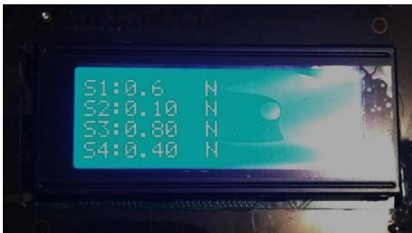
Fig. 10 Resultados desplegados en LCD con los cuatro sensores.
