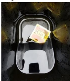
Figura 8. Proceso de eliminación de exceso de cobre.
