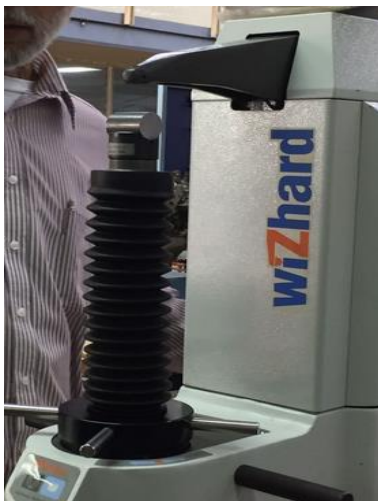
Figura 3. A la izquierda. Durómetro digital Wizhard serie 810; prueba de dureza al espécimen de prueba de acero 1045. Figura 4. Al centro. Los punto brillantes en la parte central del cuerpo de la pieza, indican la penetración del instrumental del medidor digital de dureza. Figura 5. A la derecha. Pantalla indicadora del conteo de las muestras, el valor máximo, mínimo y la media de las medidas en el acero D2.
