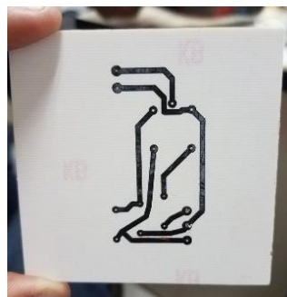
Figura 9. Pista después de sacarla del cloruro.
