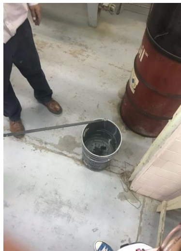
Figura 7. A la izquierda. Introducción de la pieza precalentada en un baño de agua. Figura 8. A la derecha. Reposo de la pieza en baño de agua.
