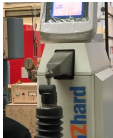
Figura 9. A la izquierda. Pieza templada de acero ASI 1040. Figura 10. A la derecha. Medición de dureza de la pieza de acero AISI 1040.
