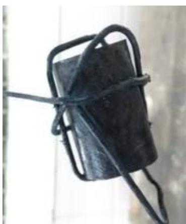
Figura 9. A la izquierda. Pieza templada de acero ASI 1040. Figura 10. A la derecha. Medición de dureza de la pieza de acero AISI 1040.
