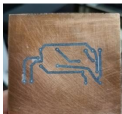
Figura 7. Placa serigrafiada por medio de planchado.
