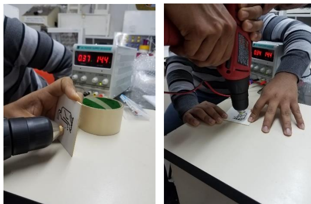
Figura 11. Perforación y prueba de continuidad en las pistas
