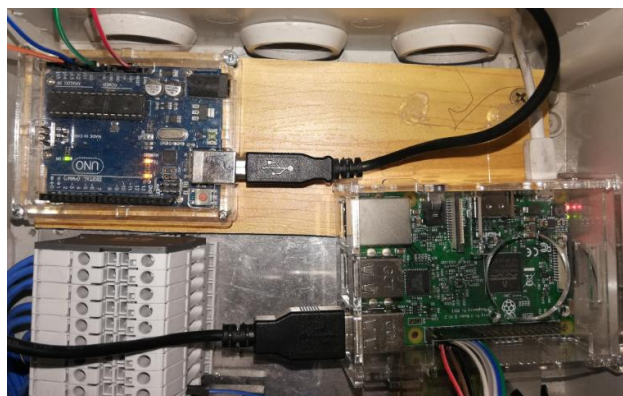
Figura 6. Conexión serial Arduino/Raspberry pi.
