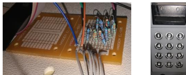
Figura 5. Circuito R-2R y teclado de máquina expendedora.
