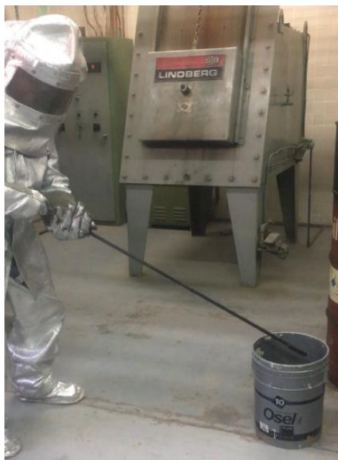
Figura 7. A la izquierda. Introducción de la pieza precalentada en un baño de agua. Figura 8. A la derecha. Reposo de la pieza en baño de agua.
