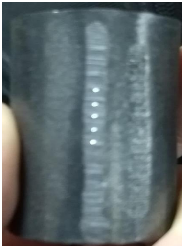
Figura 3. A la izquierda. Durómetro digital Wizhard serie 810; prueba de dureza al espécimen de prueba de acero 1045. Figura 4. Al centro. Los punto brillantes en la parte central del cuerpo de la pieza, indican la penetración del instrumental del medidor digital de dureza. Figura 5. A la derecha. Pantalla indicadora del conteo de las muestras, el valor máximo, mínimo y la media de las medidas en el acero D2.
