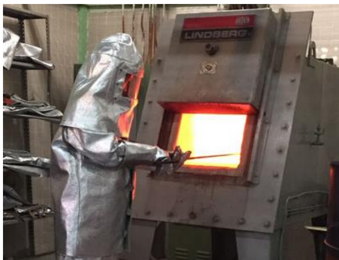
Figura 6. Calentamiento de piezas en horno eléctrico tipo Batch marca Lindberg.
