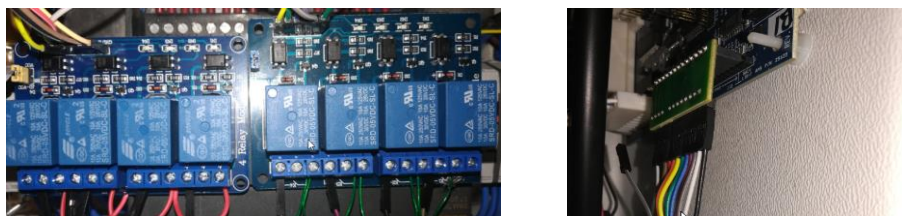
Figura 7. Conexión Raspberry pi /Relevadores / MDB maestro.
