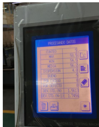
Figura 3. A la izquierda. Durómetro digital Wizhard serie 810; prueba de dureza al espécimen de prueba de acero 1045. Figura 4. Al centro. Los punto brillantes en la parte central del cuerpo de la pieza, indican la penetración del instrumental del medidor digital de dureza. Figura 5. A la derecha. Pantalla indicadora del conteo de las muestras, el valor máximo, mínimo y la media de las medidas en el acero D2.
