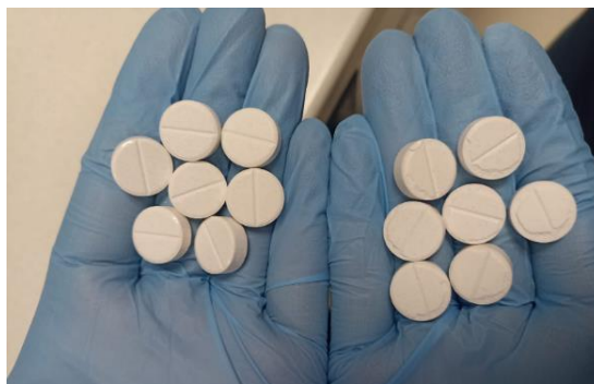
Figura 5. Comparación de tabletas obtenidas, en la izquierda tabletas con granulado de lactosa + PVP + copolímero, a la derecha tabletas sin el copolímero incorporado.
