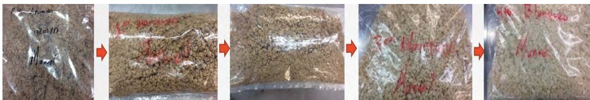
Figura 4. Procesos de blanqueo de la pulpa.
