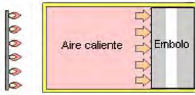
Figura 1 calentamiento del aire dentro de un cilindro
