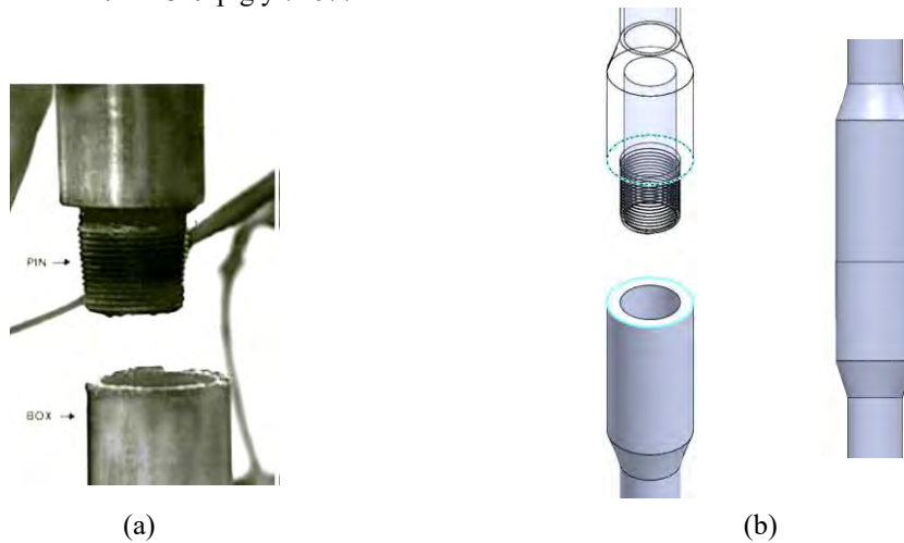
Figura 3. Conexión Grant XT-39 entre tuberías de perforación: a) imagen real, b) modelo en Solidworks.
