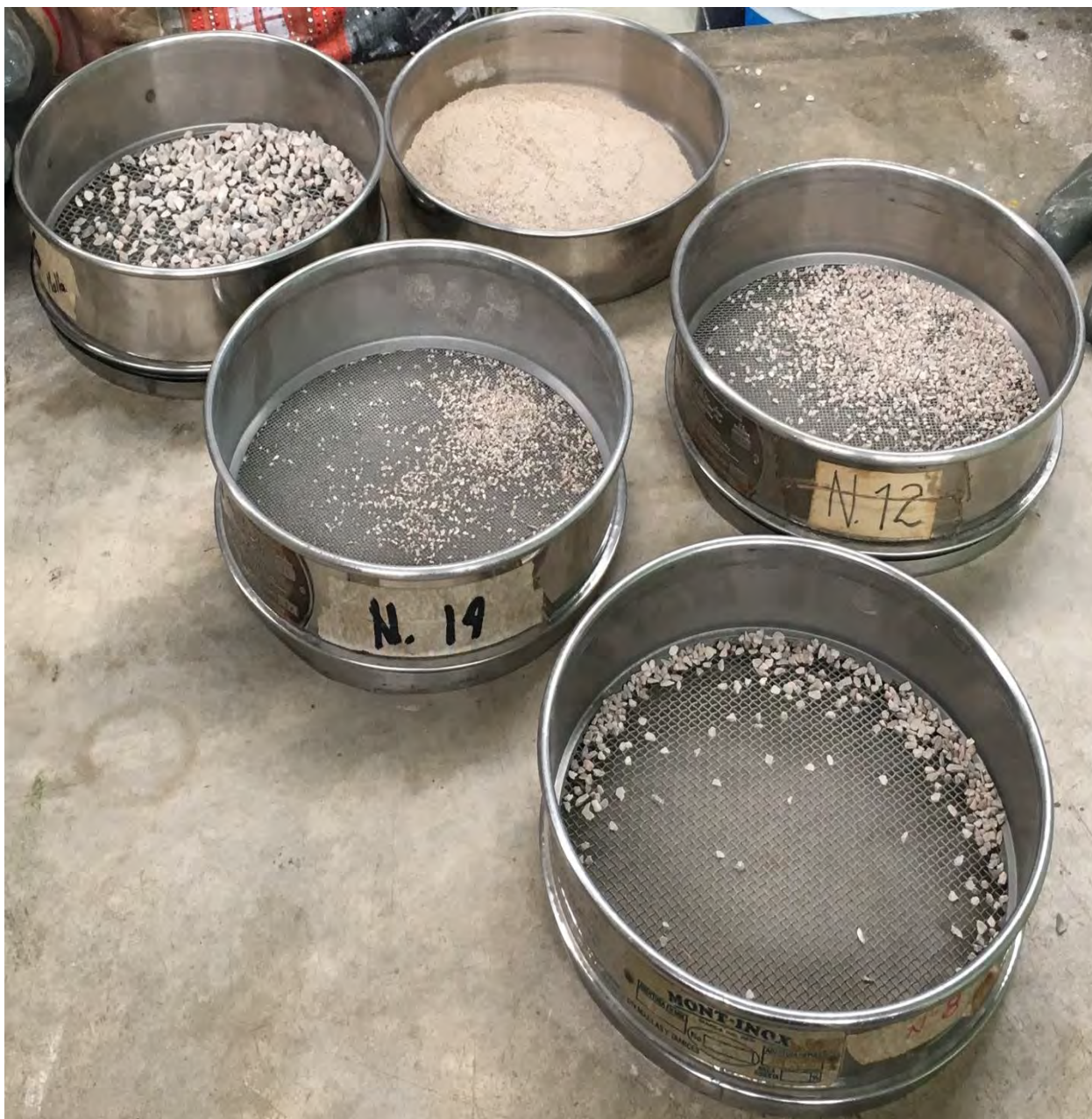
Figura 4. Cribado por diferentes mallas la muestra obtenida en el banco de arena.
