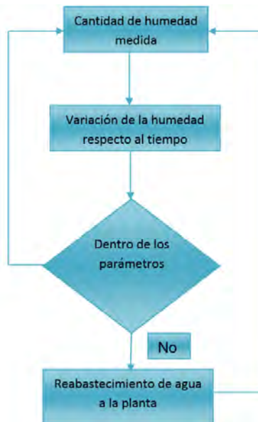
Figura 2. Diagrama esquemático del proceso de monitoreo del sistema de riego.
