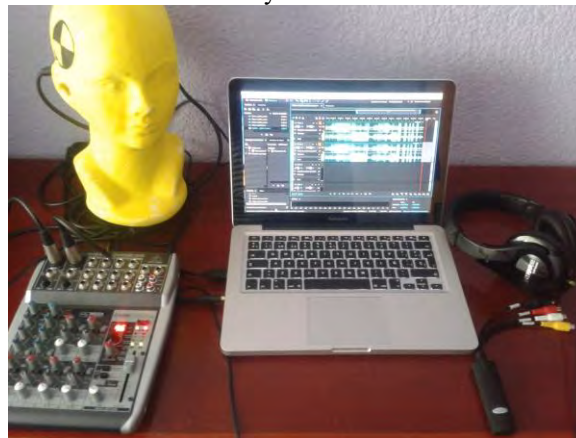
Figura 3. Equipo completo para grabación de Sonido 3D
