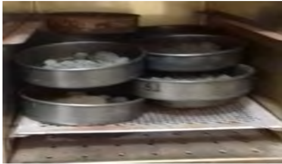
Figura 4. Prueba de contenido de humedad
