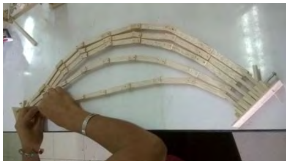
Fig.1- Representación de la concha acústica trabajada con madera balsa.
