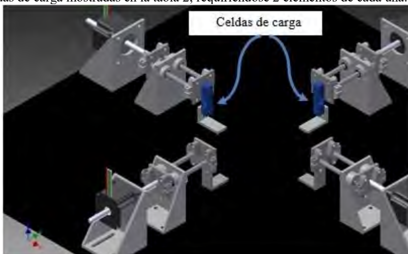
Figura 2 Ubicación de las celdas de carga en la máquina de ensayos biaxial.
