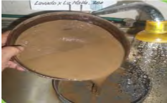
Figura 6. Prueba de granulometría vía húmeda
