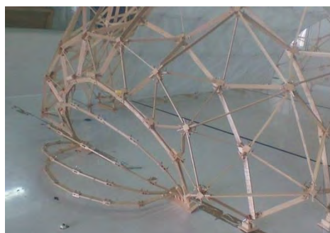
Fig.-2 Unión de la cúpula con la geodésica retráctil. Maqueta a base de madera balsa, escala 1:20.
