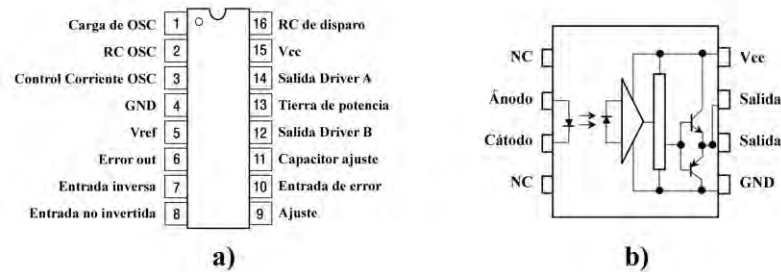
Figura 2. Configuración de pines del a) circuito oscilador MC34067 y b) Driver TLP250.
