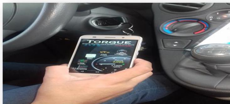
Fig. 5 Conexión vía Bluetooth con la herramienta Torque.
