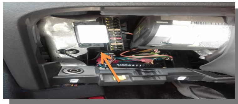
Fig. 4 Conexión del escáner ELM327 en el Automóvil.
