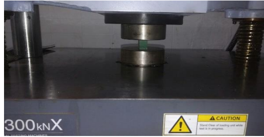
Figura 4.11 probeta del material de NECURON 1001 instalada en la maquina universal SHIMADZU
