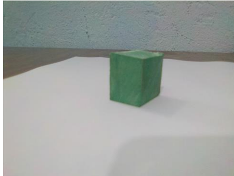
Figura 4.17 probeta del material de NECURON 1001 antes del ensaye de compresión
