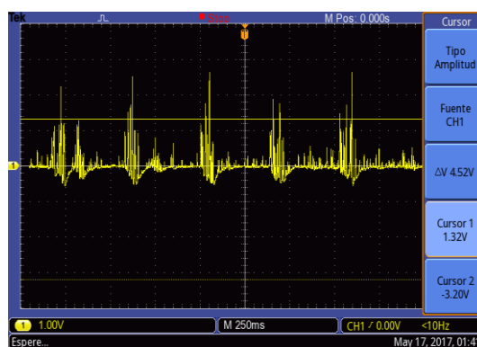
Fig.4. Señal Mioeléctrica Obtenida y vista en un Osciloscopio
