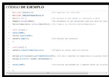
Figura 7.- Código de programación para sensor de temperatura
