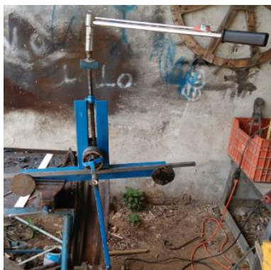
Figura 22. Torsiómetro en tornillo para deformación plástica
