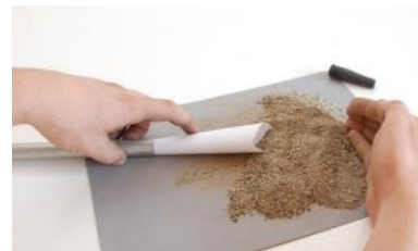
Figura 5. Rellenado para doblar el molde
