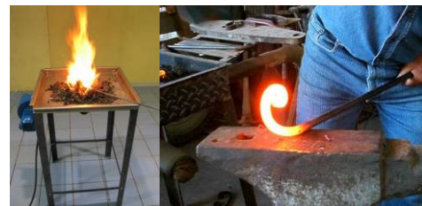
Figura 3. Forja en agua y moldeado a golpe
