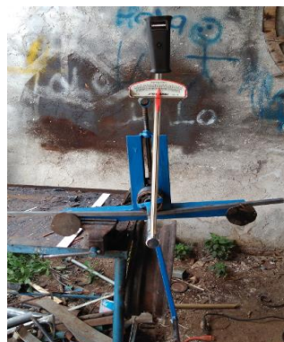
Figura 23. Torsiómetro en Rodamiento para fuerza de Rolado.
