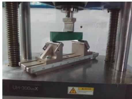
Figura 4.20 probeta instalada en la maquina Universal SHIMADZU
