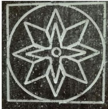
Ilustración 4: Maquinado que muestra la precisión de trayectorias de la CNC
