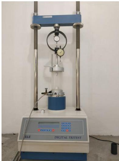
Figura 2. Cámara de compresión triaxial.
