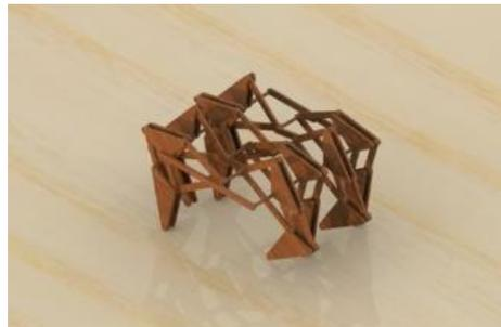
Figura 7. Mecanismo caminante de 8 patas modelado en plataforma de CAD.
