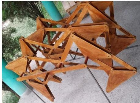
Figura 12. Tercer prototipo de mecanismo de Theo Jansen, generado por algoritmos genéticos.
