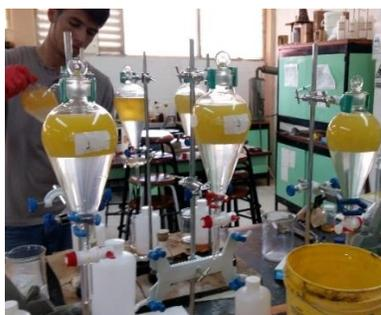
Figura 5: Lavado del biodiesel con el agua condensada de los aires acondicionados fuente propia
