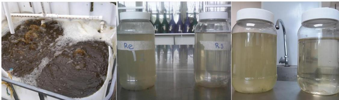
Figura 7.- Muestra del reactor SBR, operando, en la imagen central resultados con un TRH de 15 horas y a la derecha un TRH de 20 horas.
