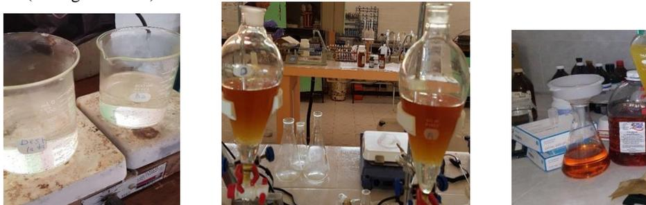
Figura 2 prelavado y secado del aceite
