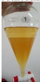
Figura 4 Transesterificación Tiempo de reacción separación de la glicerina y el biodiesel fuente propia
