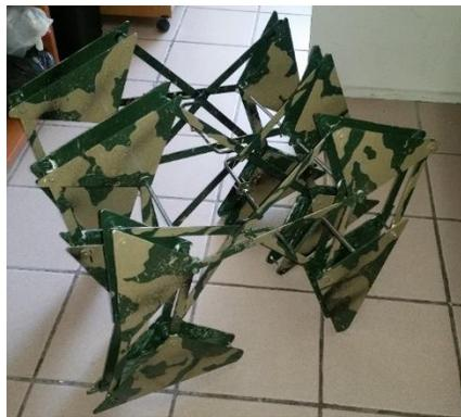
Figura 10. Primer prototipo de mecanismo de Theo Jansen.
