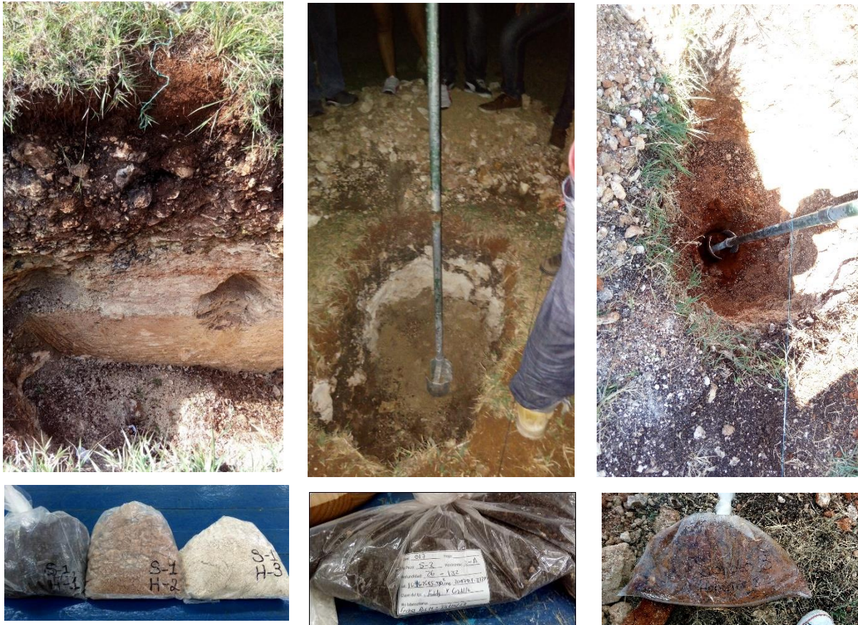
Figura 3 Perfiles de Sondeos S1, S2 y S3 y algunas muestras obtenidas en los sitios de estudio
