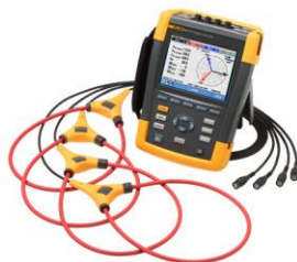
Imagen 2 – Analizador de redes Fluke 434-II
