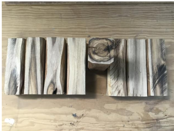
Figura 2. Probetas utilizadas para el ensayo de resistencia a la compresión.
