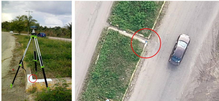
Figura 2. (Izquierda) Medición geodésica de puntos de control terrestre. Obsérvese el tipo de marcas en forma de L puestas en el terreno para ser observadas en las fotografías aéreas. El círculo en color rojo indica el punto a nivel centimétrico en donde se realiza la medición con el receptor GPS móvil. (Derecha) Marca de control terrestre que se aprecia en una de las fotografías aéreas adquiridas. La bandera azul corresponde al marcaje de control terrestre para brindar de georreferencia al modelo fotogramétrico.
