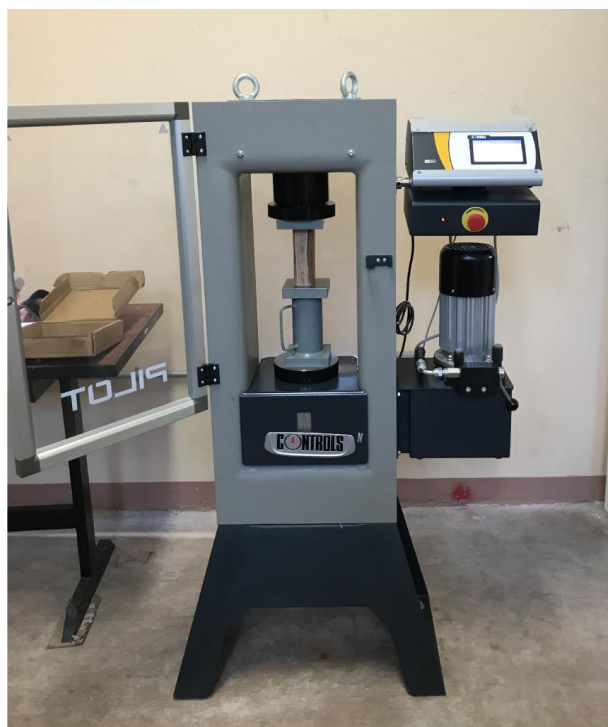
Figura 3. Ensayo de compresión de la madera de Mimosa lactiflua .
