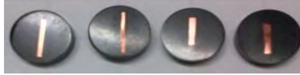
Figura 1. Probetas preparadas para la micrografía a las diferentes temperaturas de envejecimiento térmico
