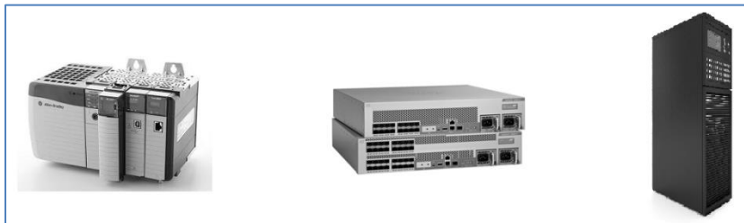
Figura 3. Conexión del PAC con el servidor a través de un switch Ethernet.
