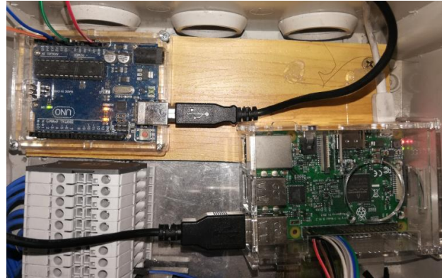
Figura 6. Conexión serial Arduino/Raspberry pi.
