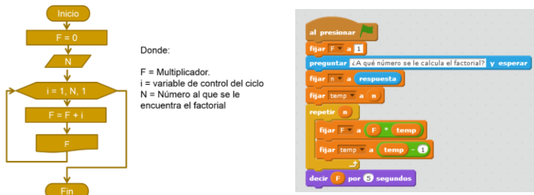
Fig. 5. Diagrama de flujo y código en scratch del problema con estructura cíclica
