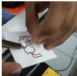
Figura 12. Soldado de los componentes que componen la placa.
