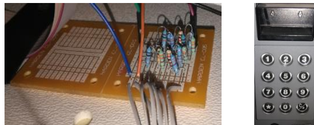
Figura 5. Circuito R-2R y teclado de máquina expendedora.
