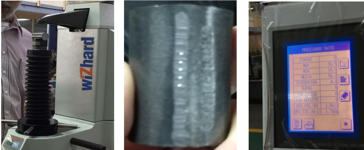
Figura 3. A la izquierda. Durómetro digital Wizhard serie 810; prueba de dureza al espécimen de prueba de acero 1045. Figura 4. Al centro. Los punto brillantes en la parte central del cuerpo de la pieza, indican la penetración del herramental del medidor digital de dureza. Figura 5. A la derecha. Pantalla indicadora del conteo de las muestras, el valor máximo, mínimo y la media de las medidas en el acero D2.
