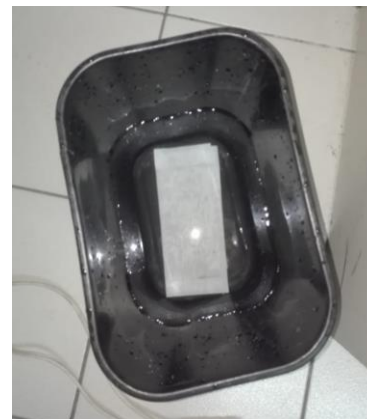
Figura 6. Placa sumergida en agua para remover el papel.
