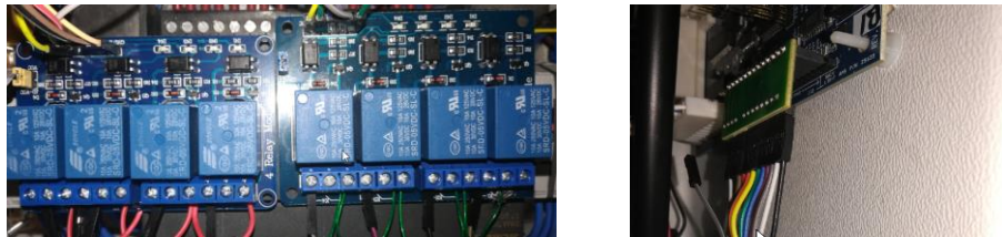
Figura 7. Conexión Raspberry pi /Relevadores / MDB maestro.
