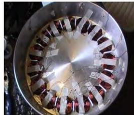
Fig. 7. Conexión de bobinas del estator (Fuente: Propia).
