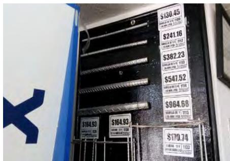
Figura 3. Acero de refuerzo de resistencia normal 4200kg/cm<sup>2</sup>.
