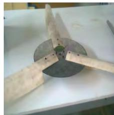
Fig. 11. Colocación de las aspas en el disco (Fuente: Propia).
