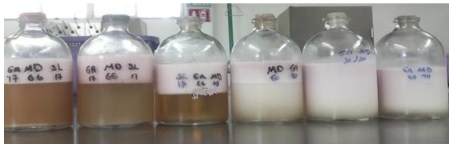
Figura 1. Emulsiones realizadas con diferentes concentraciones de polímero, de izquierda a derecha; GM 17%-Md 66%-SL 17%, GA 17%-Md 66%-SL 17%, GA 66%-Md 17%-SL 17%, GA 40%-Md 60%, GA 50%MD 50%, GA 60%-Md 40%
