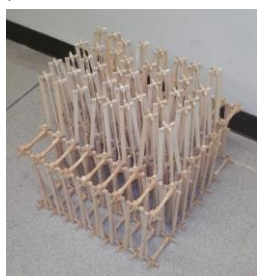
Figuras.-7 al 10: El armado de los contra vientos fue una de las conexiones claves para funcionalidad de cubierta. En este caso, cada módulo que se conectó, fue observado si se plegaba correctamente. Fuente: Fotos Experimentales. Morales, (2010).
