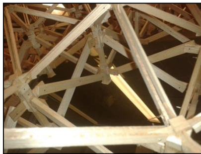
Figura.- 2, 3: El modelo escalado a 1:20 ayudó a conceptualizar la elaboración del nodo constructivo, de igual manera la utilización de un software especializado ayudó a modelar con más eficiencia las conexiones que podría tener el sistema plegable de la cubierta. Fuente: Fotos Experimentales. Morales, (2011).
