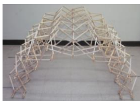
Figuras.-7 al 10: El armado de los contra vientos fue una de las conexiones claves para funcionalidad de cubierta. En este caso, cada módulo que se conectó, fue observado si se plegaba correctamente. Fuente: Fotos Experimentales. Morales, (2010).
