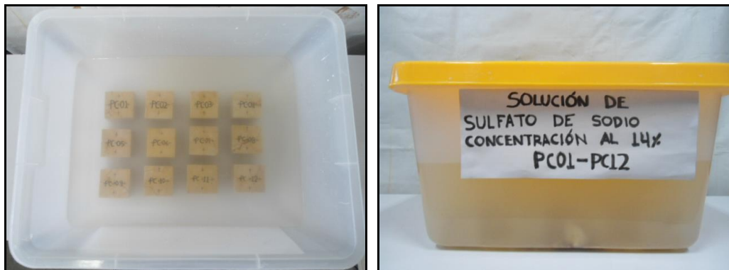
Figura 7. Fotografía de las 12 probetas inmersas en solución salina de sulfato de sodio al 14%
