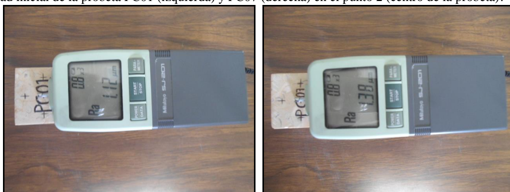
Figura 6. Fotografías de la medición de la rugosidad inicial de las probetas PC01 y PC07
