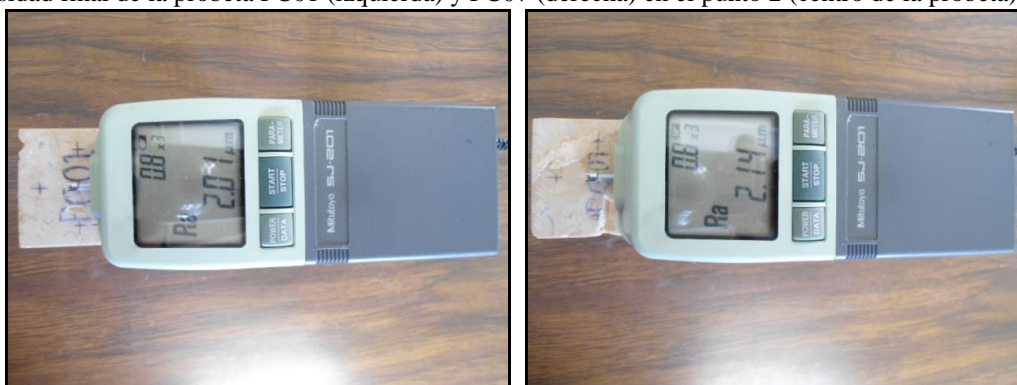
Figura 10. Fotografías de la medición de la rugosidad final de las probetas PC01 y PC07
